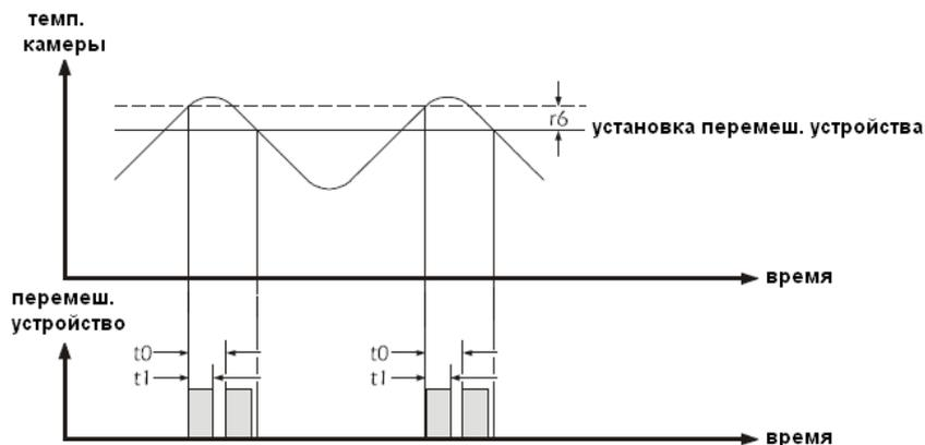
Если параметры **r11** и **r10** имеют значение 1, то перемешивающее устройство будет работать циклически в соответствии с ниже указанными графиками.
