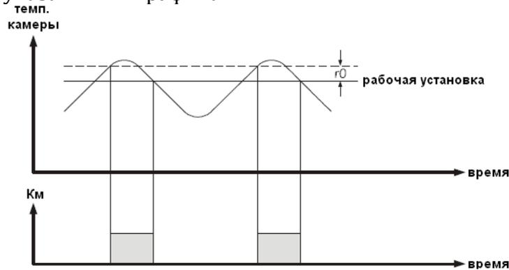
Если параметр **r5** имеет значение 1, то компрессор будет работать в соответствии с ниже указанными графиками.
