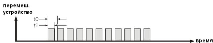
Если параметр **r12** имеет значение 1, то перемешивающее устройство будет активироваться при активации компрессора; если параметр **r12** имеет значение 2, то перемешивающее устройство будет активироваться при выключении компрессора.
