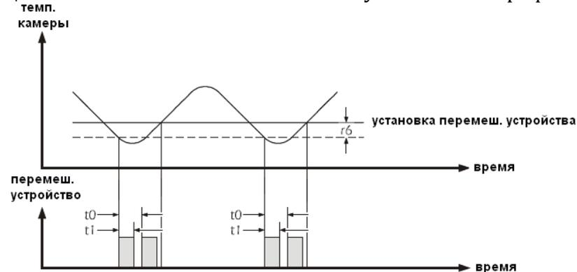
Если параметр **r12** имеет значение 1, то перемешивающее устройство будет активироваться при активации компрессора; если параметр **r12** имеет значение 2, то перемешивающее устройство будет активироваться при выключении компрессора.
