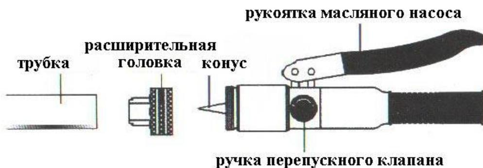
1. Важно! Используйте для работы только отождённую медную трубу. Если для расширения используется неотождённая труба, перед работой обязательно отождите трубу в месте расширения.
